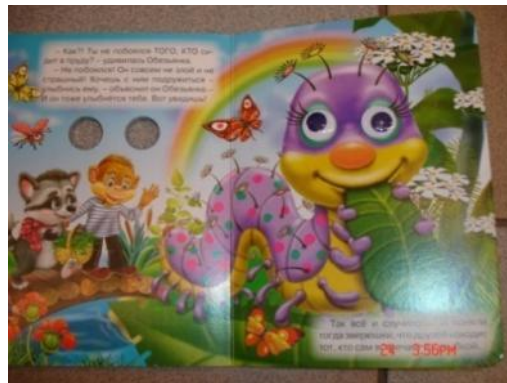
Attēls Nr.2 Pārbaudīto grāmatu-rotāļlietu piemēri, kas radīja pamatotas aizdomas par neatbilstību drošuma būtiskajām prasībām (Satur, iespējams, viegli atdalāmas detaļas (acis), kas ir tik mazas, ka pilnībā ietilptu sīko detaļu cilindrā)
